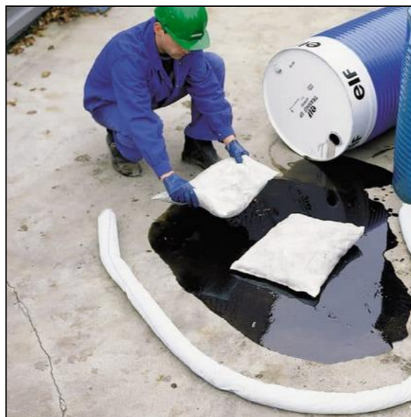
Photographie 11 : Kit anti-pollution utilisé sur une fuite d'hydrocarbures (Source : HALECO)
